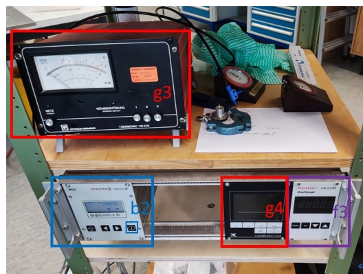
Abbildung 2.3: Der Pumpstand für den Vakuumbehälter. Hier ist b2) die Steuerung der Turbomolekularpumpe, f3) die Anzeige der Manometer (kann zwischen Unterem und Oberem umgeschaltet werden) und g3) die analoge Anzeige des Manometers.
