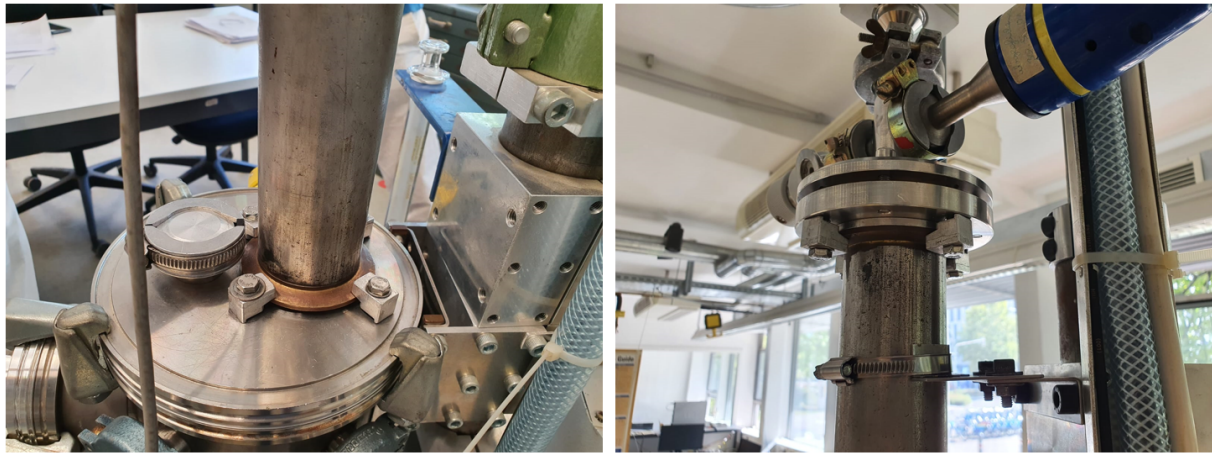
Abbildung 3.3: Links: Der untere Rohrflansch auf dem Deckel der Vakuumkammer. Rechts: Die Rohrschelle (unten) und der obere Flansch (oben).
